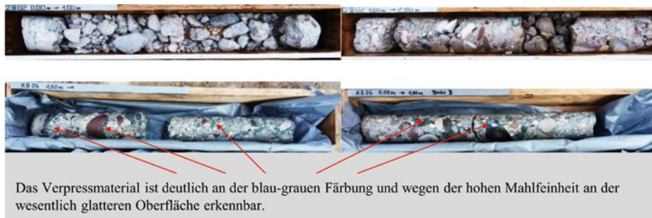
Bild 6: Bohrkerne vor (oben) und nach den Injektionen (unten)
